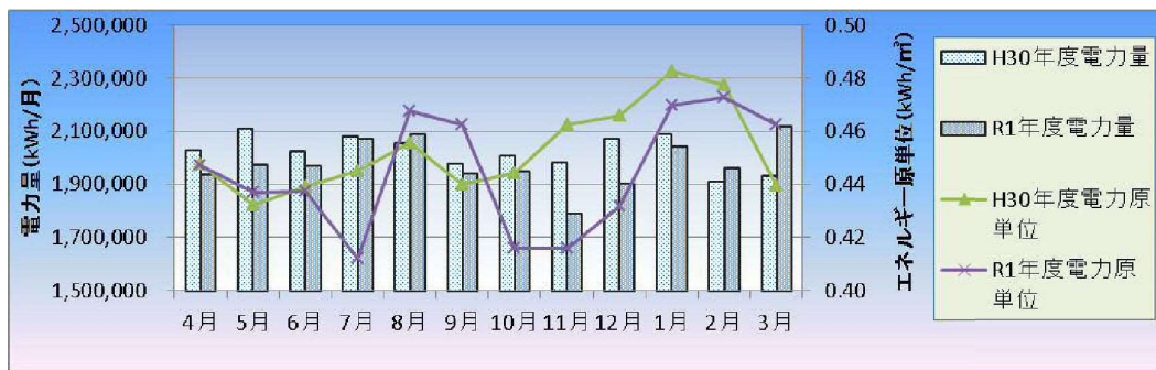
図9 西遠浄化センターの使用電力量及び電力原単位
