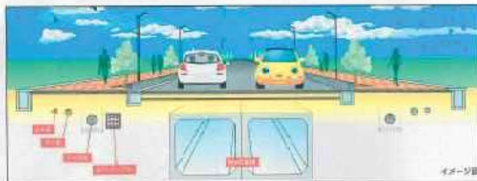
基あたり 幅5.6m×高さ3.0m×奥行1.6m 合計 71基 延長100m
