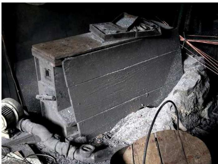
片桐鍛冶店で焼き入れや焼き戻しをする時に使用した鞆です。鞆には、空気を取り込む吸入弁と排出する排出弁があり、箱の中の獣の皮で覆った板を柄で押し引きすることで往復させ、炉側の下部中央の吹き口から風を送り出します。
