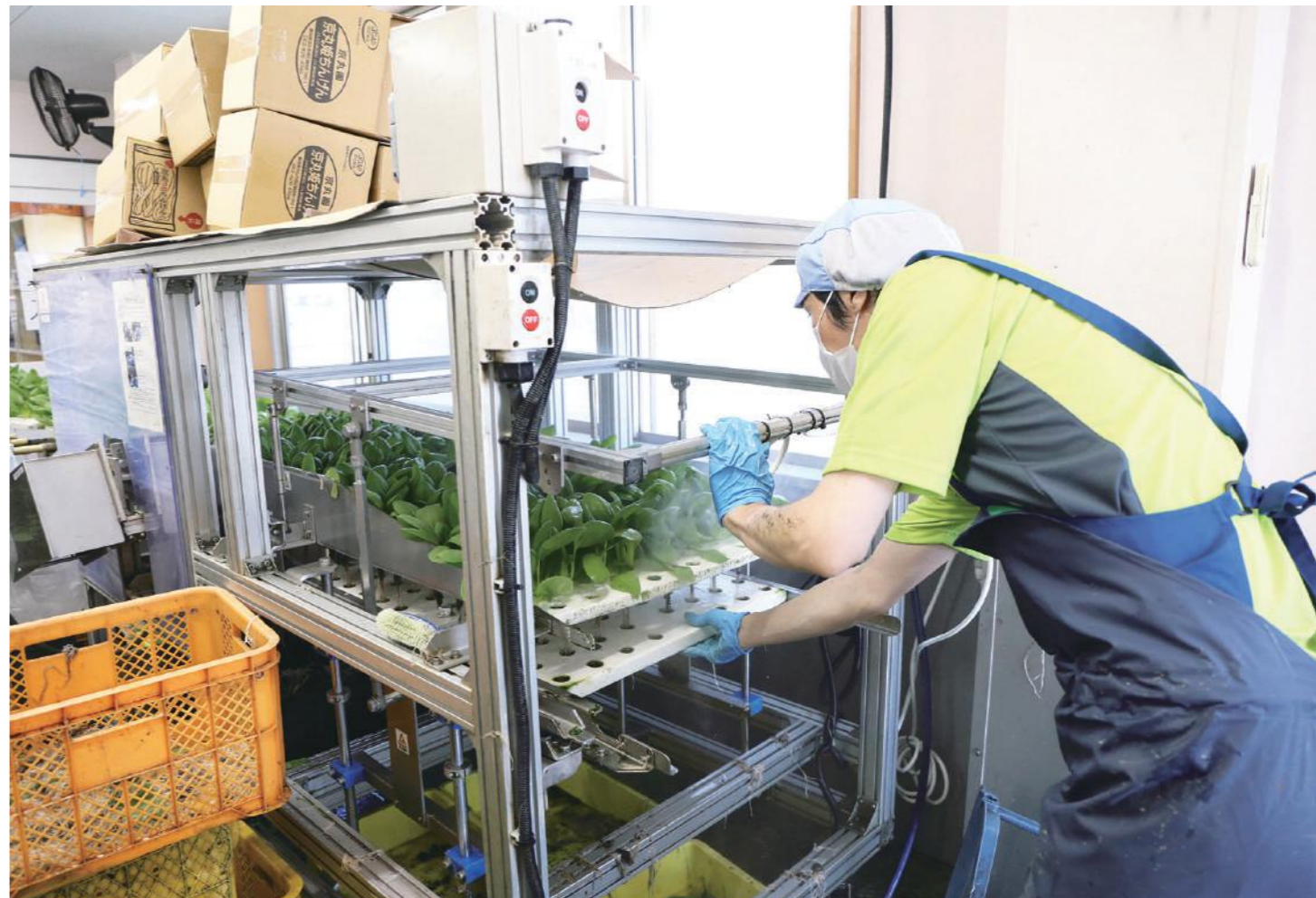
ウレタンに植えられたチンゲンサイが、出荷調整ラインに入る行程で、根を一次カットする機械。2枚になったウレタンの1枚を分離させ、押し込むことで自動的に根がカットされる。
