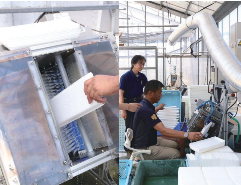
左：当初開発した回転するブラシに抜き差しすることで効率よく洗浄できるトレー洗い機。現在は、横からスライドする方式でさらに効率性を高めたものを京丸園では使っている。障がいのある方がバランスを崩したときも対応できる安定性を備え、作業者に合わせて角度を変えられるなど、細部に配慮がなされている。
