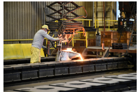
1500度にもなる溶けた材料「溶湯」を砂型に流し込む「鑄込み」工程
