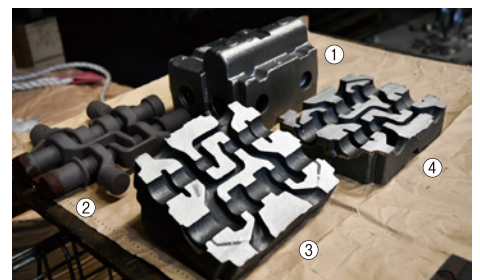
①完成した油圧部品 ②鑄型の中にはめ込む砂型「中子（なかご）」 ③④完成品を半分に切断したもの。中子により、部品の中に複雑な中空の成形ができる
