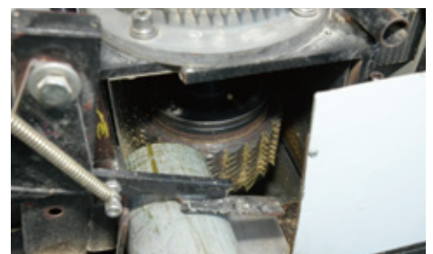
PANDAの内部。円盤状の鋸を重ね合わせて高速回転させ、竹の断面をカンナがけのように滑らかに切削し、5μmの竹粉を製造
