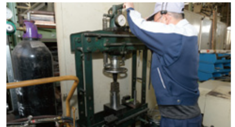
自ら設計した製品図面をもとに、金型の中に材料を固定し、ハンドプレスで成型。
