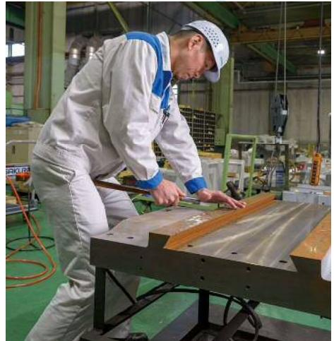
すべり面にスクレーパーの刃を当て、柄を足の付け根に固定。左手は押さえるように、右手は引き上げるように力を加えて、腰と膝の力を使って柄をしならせ、加工面を削り取っていきます。
