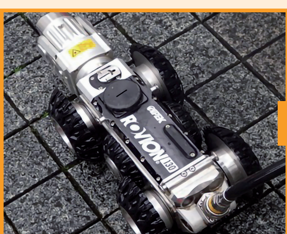
下水道管を調べるロボット
