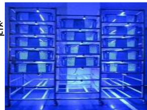
【貯蔵農産物鮮度保持装置】フレームからなる多段ラックに取付けた照明器からコンテナに貯蔵する農産物に青色光を照射して腐敗を抑制する装置。
