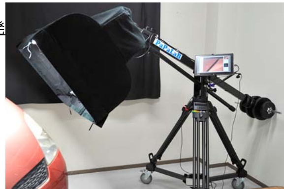
⇓ 自動車用メタリック塗装評価装置 クレーンを使って、自動車ボディの各パーツ(ドアやフェンダー、オイルキャップ等)の境目の評価が可能。
