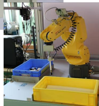
FANUC社製、多関節▽ロボットと組み合わせた自動ピッキングシステム
