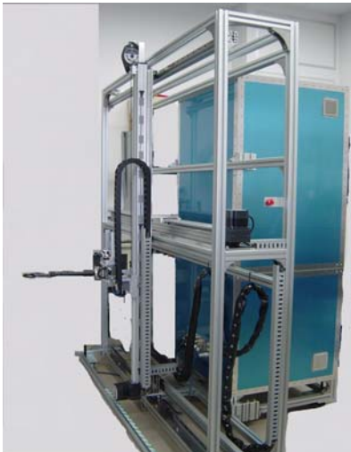
【大型製品向け近傍界ノイズ測定システム】 (測定範囲1500×1500mm)
