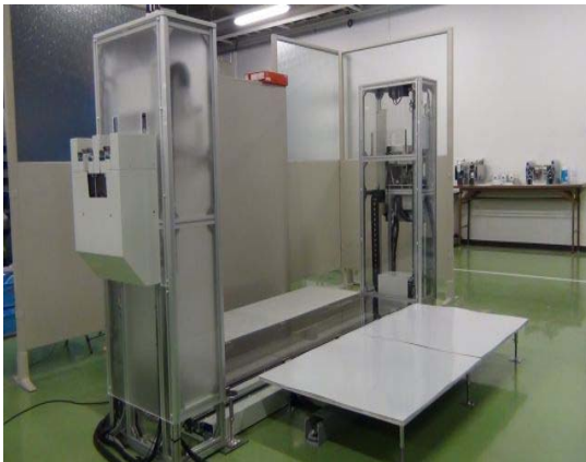
【マテハンシステム全体(床下コンベヤ・リフター装置)】
