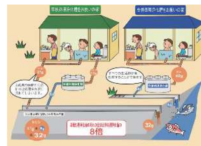
合併浄化槽と単独浄化槽の比較
