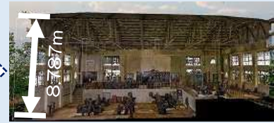
実寸法による測量が可能 （仮に損傷した場合もデータ保存により復元可能）
