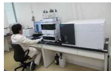
PFAS測定用分析装置（2021年度導入） 〔大原浄水場〕
