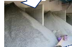
機械脱水後の浄水発生土 [大原浄水場]
