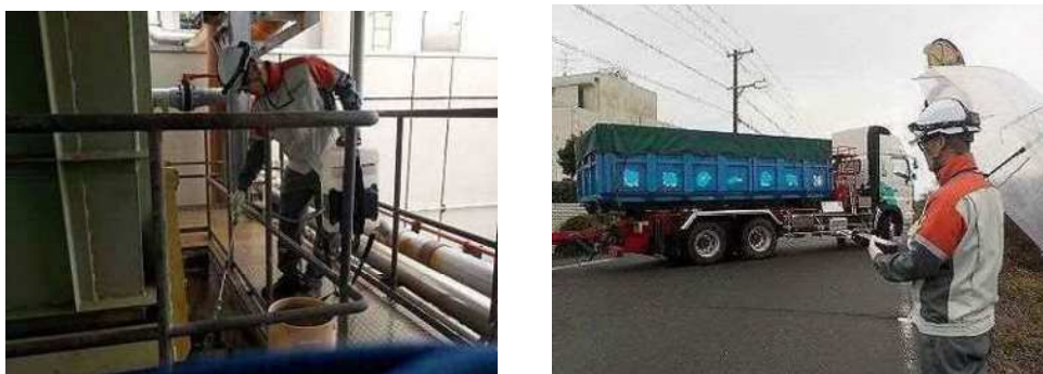
図 7 車両の荷台へ消臭剤散布及び臭気センサーを用いた臭気測定
