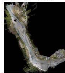
VTOL機撮影データから生成された天竜川水系のオルソ画像 （出典：株式会社フジヤマ）
