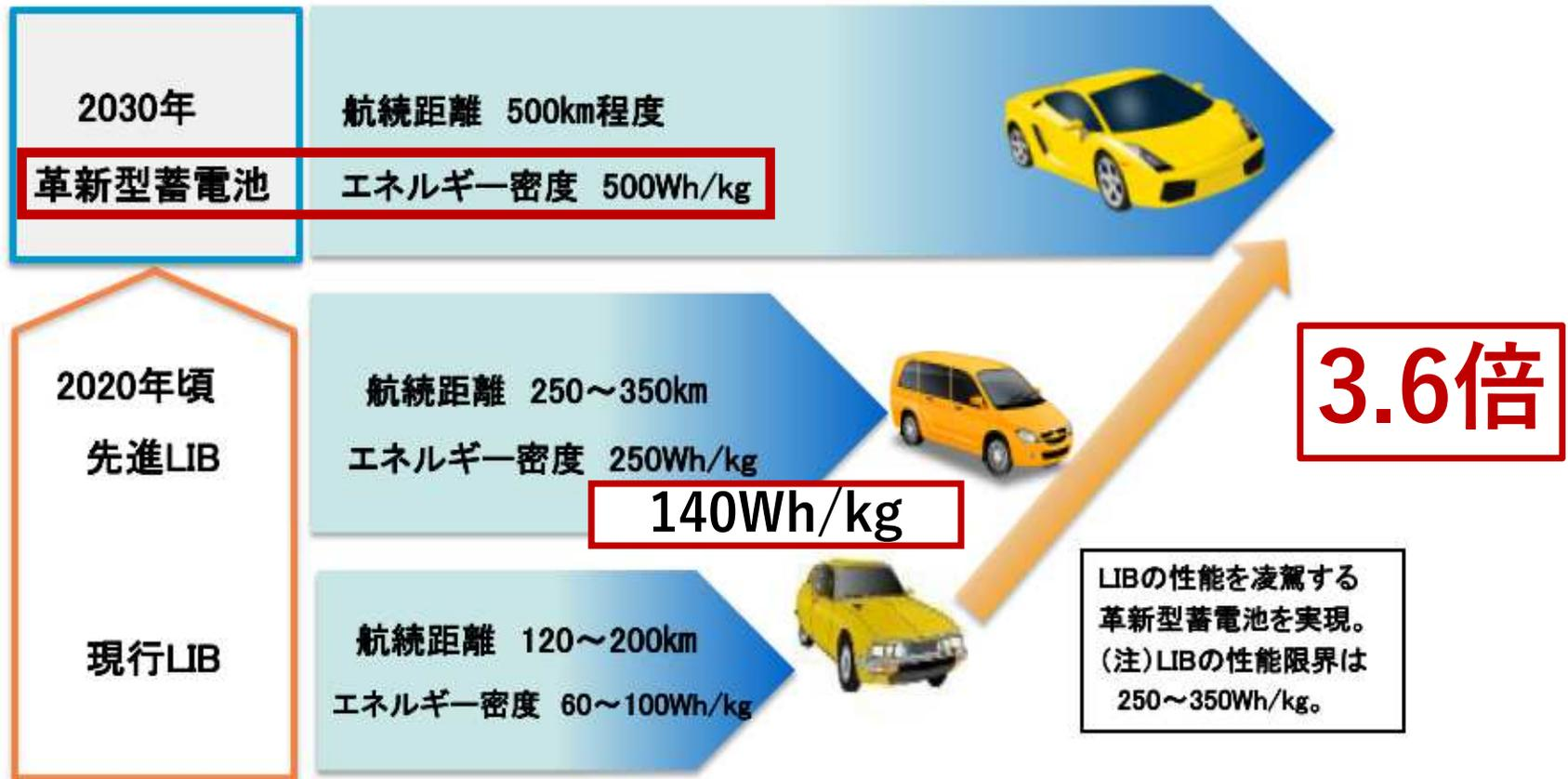
リチウムイオン電池から革新型蓄電池への飛躍
