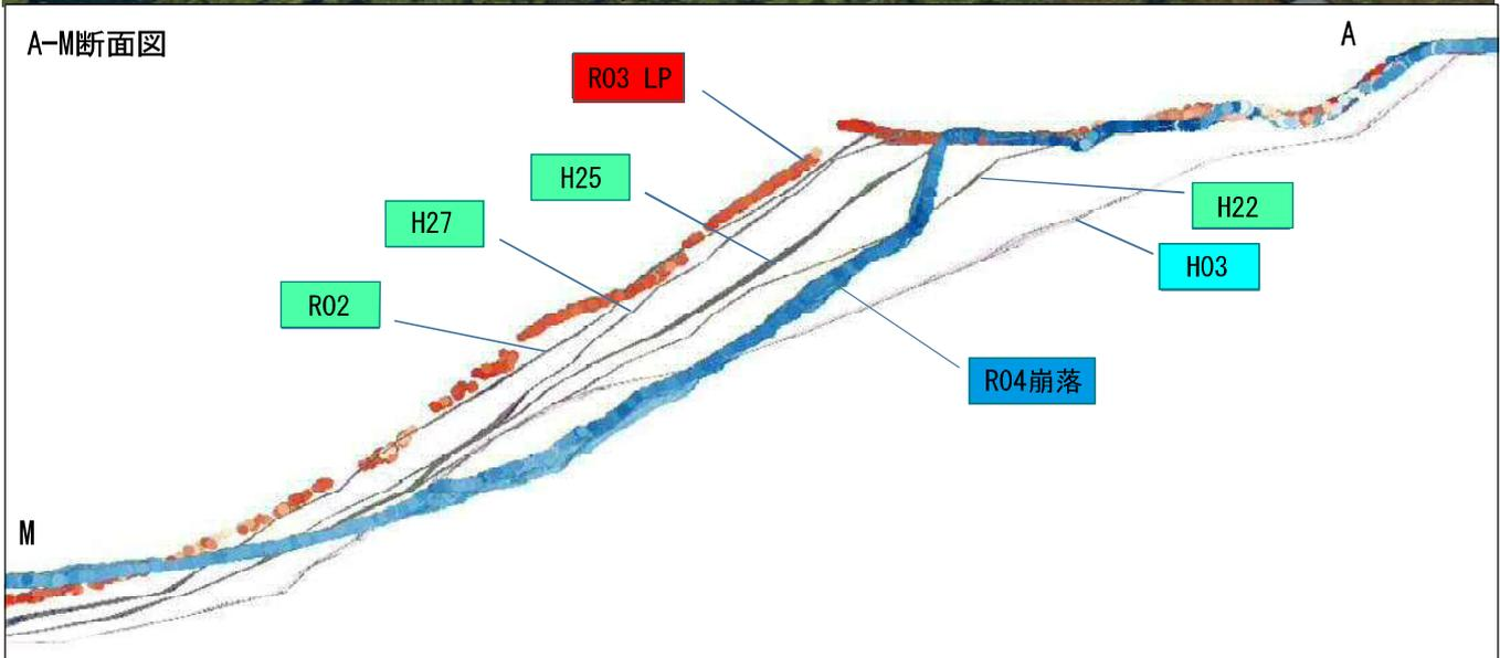
※R03LP及びR04崩落のデータは3次元点群データを基に作成したものである。
