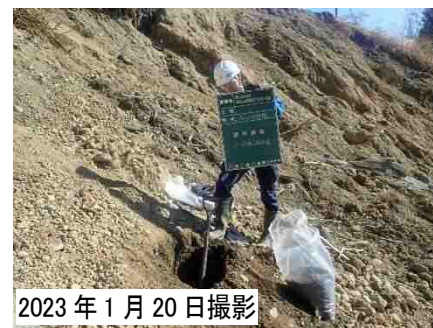
写真-4.4.2 o-B 層③(造成盛土)試料採取箇所
