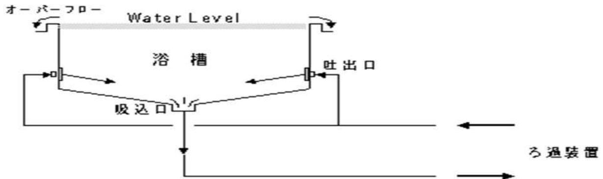
図-2 側壁吐出・底面還水方式
