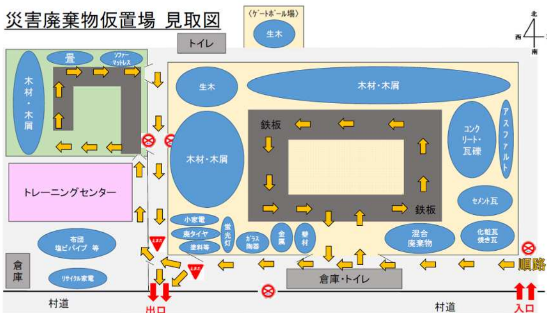
図 3.8 一次仮置場のレイアウト例（熊本地震の事例）
